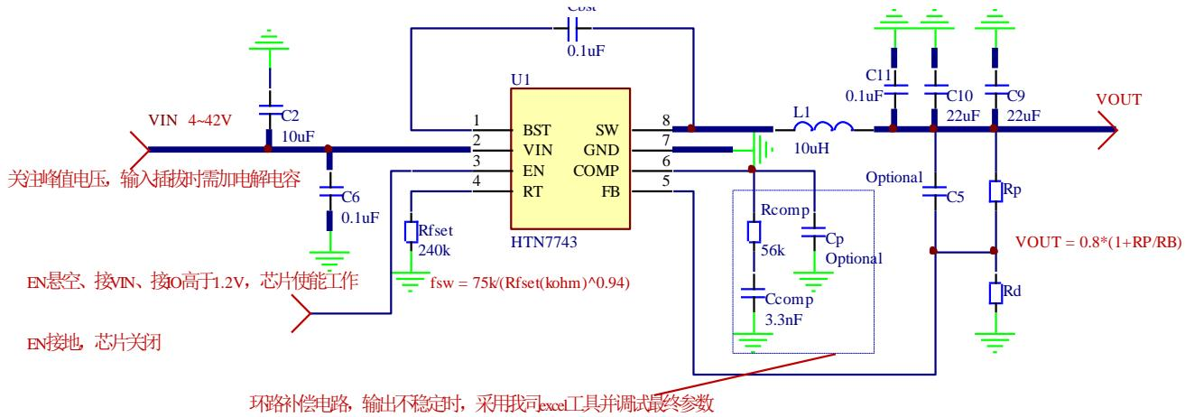
环路补偿电路，输出不稳定时，采用我司excel工具并调试最终参数
